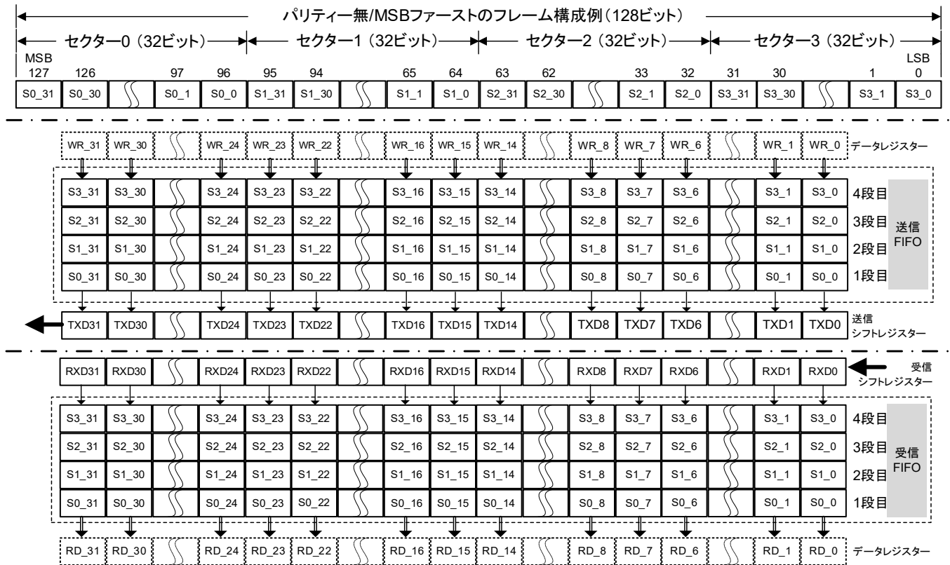
図 3.11 セクターモード/パリティ無/MSBファーストのバッファ動作
