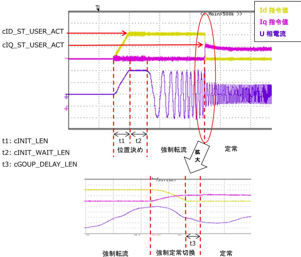
図 11.1 起動電流波形（電気角 0° に位置決め）
