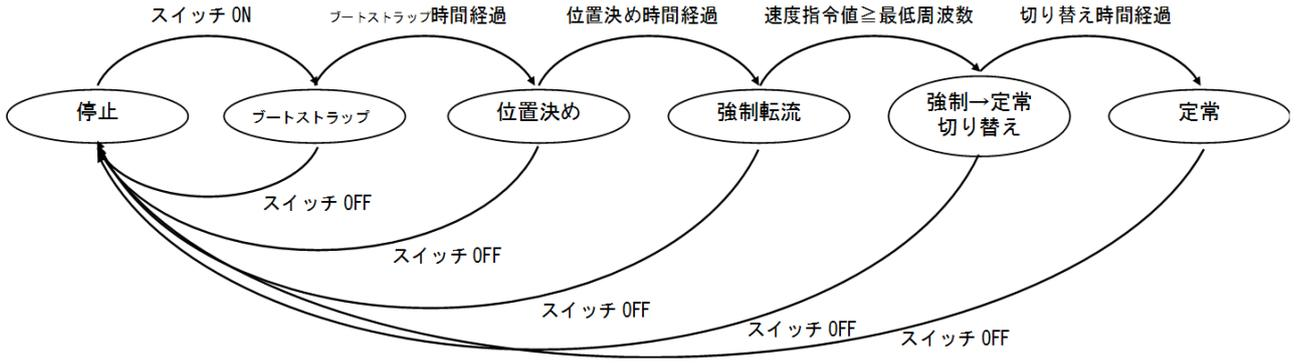
図 10.1 モーター制御の状態遷移図
