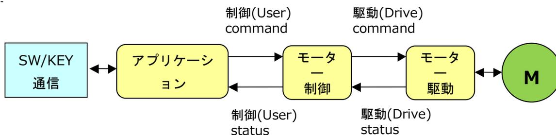
図 1.1 ベクトル制御ソフトウェアの構造
