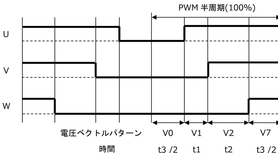
図 10.17 3 相変調時の PWM 波形
