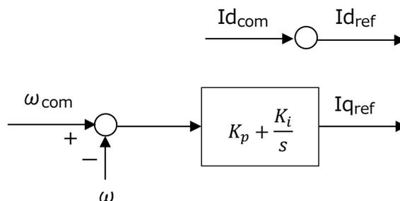
図 10.12 速度制御ブロック図
