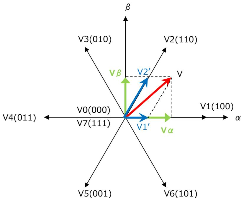
図 10.16 セクター 0 時の電圧ベクトル
