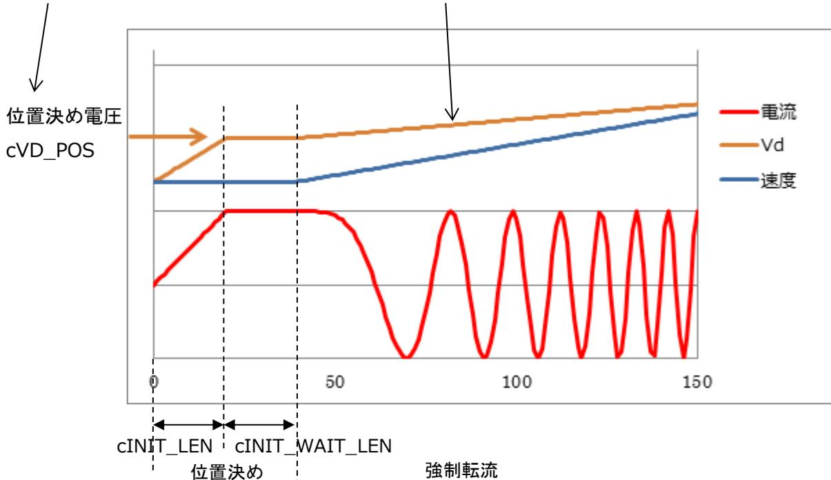
図 11.2 電圧駆動時のパラメータ調整方法
