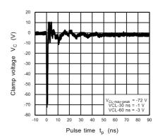
Fig. 11.12.6 ISO10605 Clamp Waveform -8 kV
