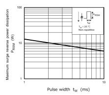
Fig. 11.1.9 P<sub>RSM</sub> - t<sub>w</sub>
