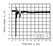
Fig. 11.11.6 ISO10605 Clamp Waveform -8 kV
