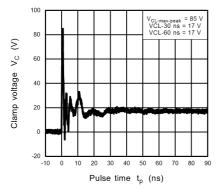
Fig. 11.12.5 ISO10605 Clamp Waveform +8 kV
