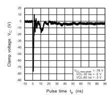
Fig. 11.10.6 ISO10605 Clamp Waveform -8 kV
