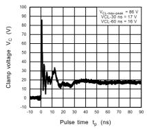
Fig. 11.11.5 ISO10605 Clamp Waveform +8 kV
