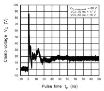
Fig. 11.10.5 ISO10605 Clamp Waveform +8 kV
