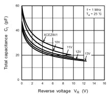
Fig. 11.1.6 C<sub>t</sub> - V<sub>R</sub> (2)
