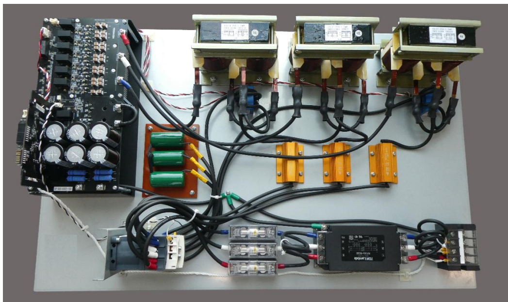
図 2.2 3 相 AC 400V 入力対応 10kW PFC 電源外観
