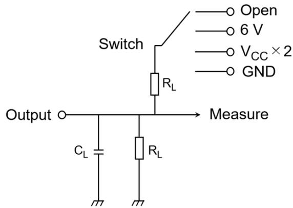
図 12.1 AC電気的特性測定回路
