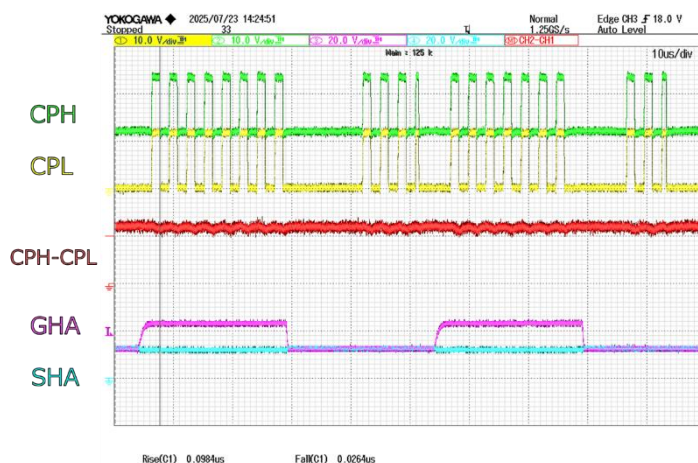
図 6.2 チャージポンプ動作波形例
