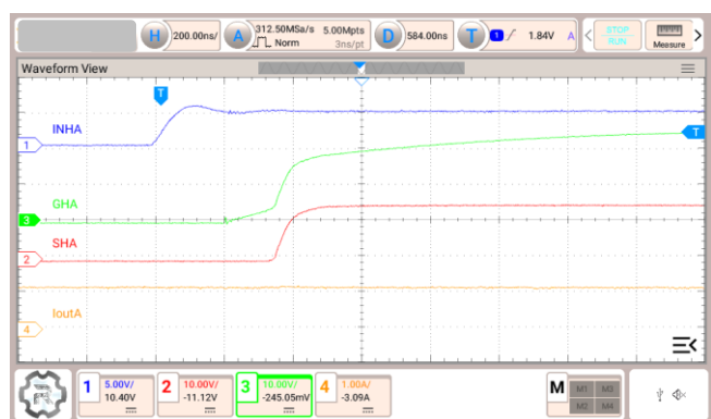
図 3.3 Isource = 120 mA, H-side 駆動, プラス電流方向
