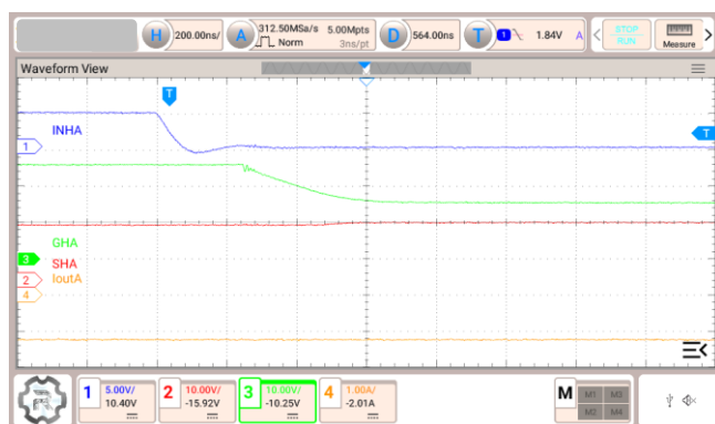
図 3.16 Isink = 240 mA, H-side 駆動, マイナス電流方向
