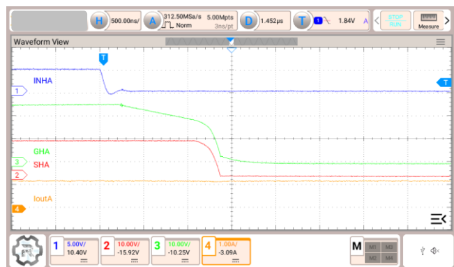
図 3.17 Isink = 60 mA, H-side 駆動, プラス電流方向
