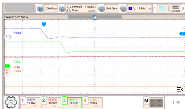
図 3.14 Isink = 2 A, H-side 駆動 マイナス電流方向
