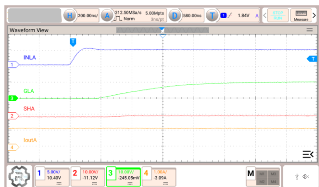
図 3.9 Isource = 120 mA, L-side 駆動, プラス電流方向
