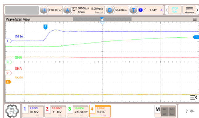
図 3.4 Isource = 120 mA, H-side 駆動, マイナス電流方向
