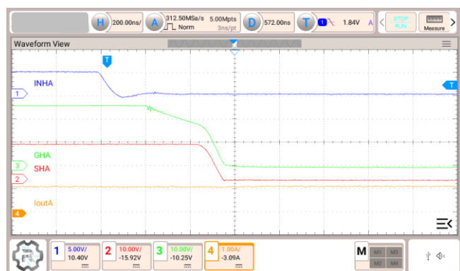
図 3.15 Isink = 240 mA, H-side 駆動, プラス電流方向
