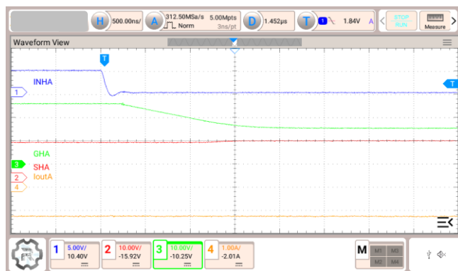
図 3.18 Isink = 60 mA H-side 駆動 マイナス電流方向
