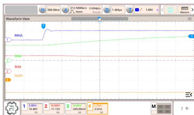
図 3.6 Isource = 30 mA, H-side 駆動, マイナス電流方向
