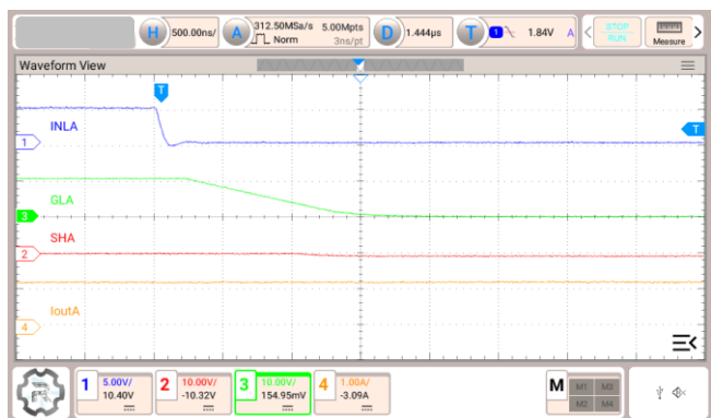
図 3.23 Isink = 60 mA, L-side 駆動, プラス電流方向
