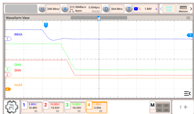
図 3.13 Isink = 2 A, H-side 駆動, プラス電流方向
