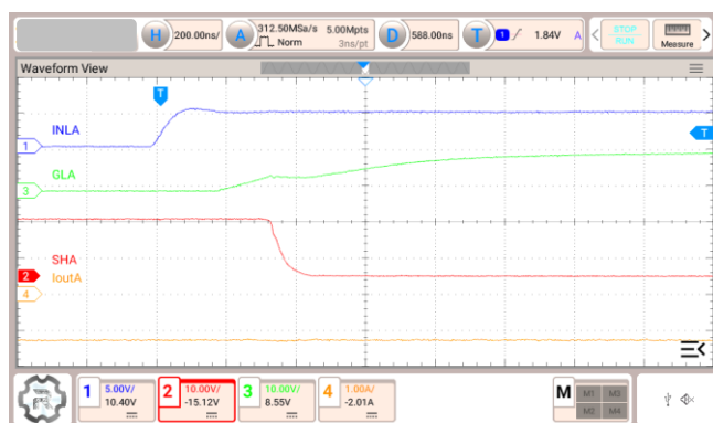
図 3.10 Isource = 120 mA, L-side 駆動, マイナス電流方向
