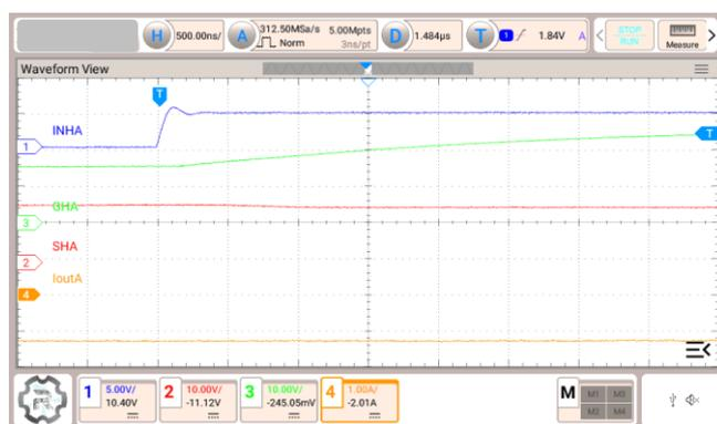
図 3.6 Isource = 30 mA, H-side 駆動, マイナス電流方向
