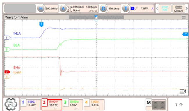
図 3.8 Isource = 1 A, L-side 駆動, マイナス電流方向
