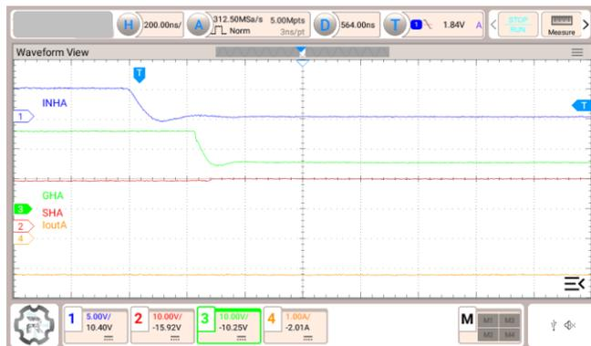
図 3.14 Isink = 2 A, H-side 駆動 マイナス電流方向
