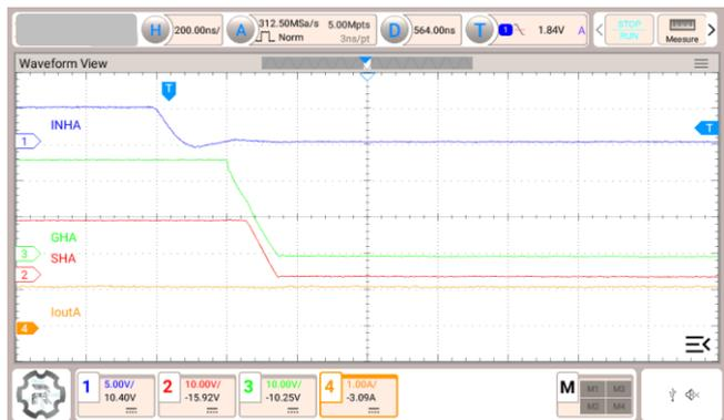
図 3.13 Isink = 2 A, H-side 駆動, プラス電流方向
