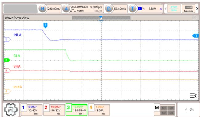
図 3.19 Isink = 2 A, L-side 駆動, プラス電流方向
