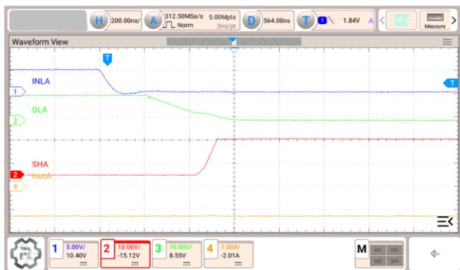
図 3.22 Isink = 240 mA, L-side 駆動, マイナス電流方向
