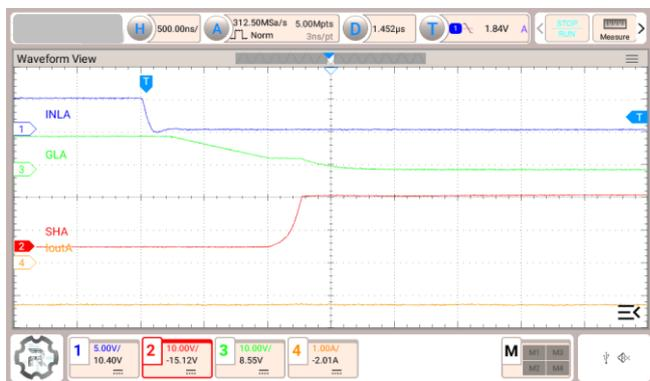
図 3.24 Isink = 60 mA, L-side 駆動, マイナス電流方向
