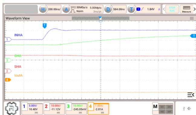
図 3.4 Isource = 120 mA, H-side 駆動, マイナス電流方向
