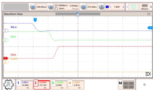
図 3.20 Isink = 2 A, L-side 駆動, マイナス電流方向
