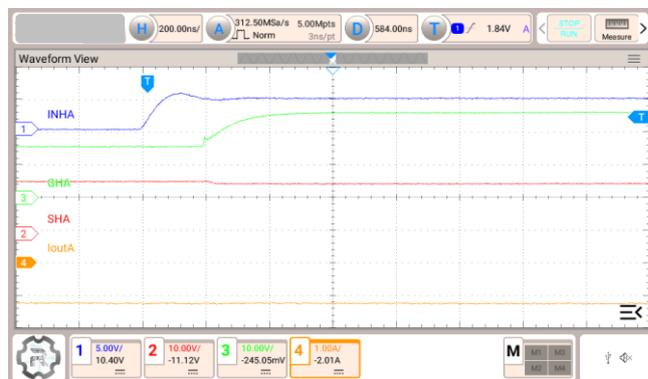
図 3.2 Isource = 1 A, H-side 駆動, マイナス電流方向
