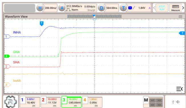
図 3.1 Isource = 1 A, H-side 駆動, プラス電流方向
