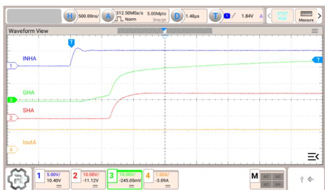
図 3.5 Isource = 30 mA, H-side 駆動, プラス電流方向
