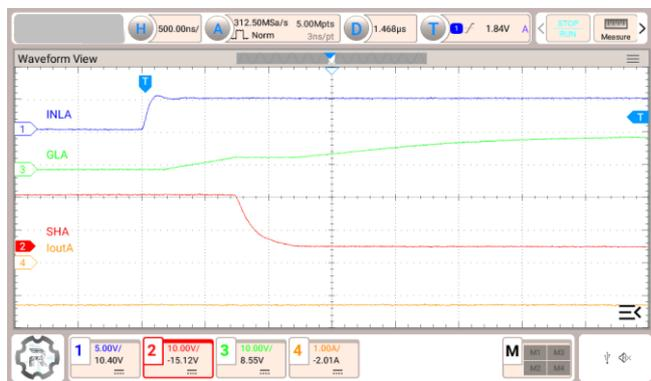
図 3.12 Isource = 30 mA, L-side 駆動, マイナス電流方向
