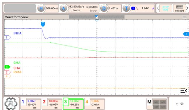
図 3.18 Isink = 60 mA H-side 駆動 マイナス電流方向
