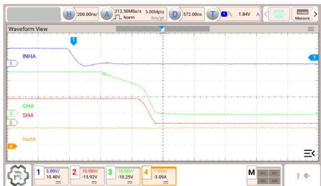
図 3.15 Isink = 240 mA, H-side 駆動, プラス電流方向
