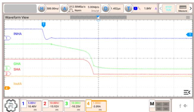
図 3.17 Isink = 60 mA, H-side 駆動, プラス電流方向
