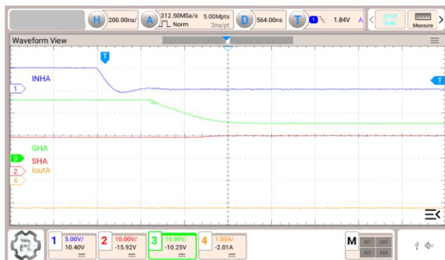
図 3.16 Isink = 240 mA, H-side 駆動, マイナス電流方向
