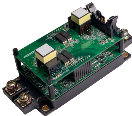
図 1.1 当社 E3D SiC MOSFET モジュールへの直上嵌合写真
