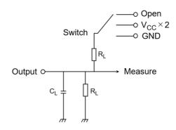
Fig. 9.7.1 AC Test Circuit
