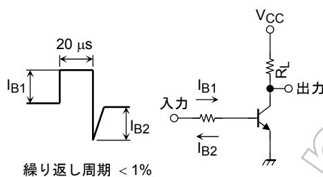
図1 スイッチング時間測定回路
