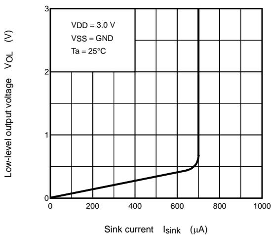
$V_{OL} - I_{\text{sink}}$
