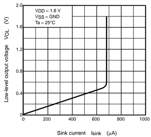
$V_{OL} - I_{\text{sink}}$
