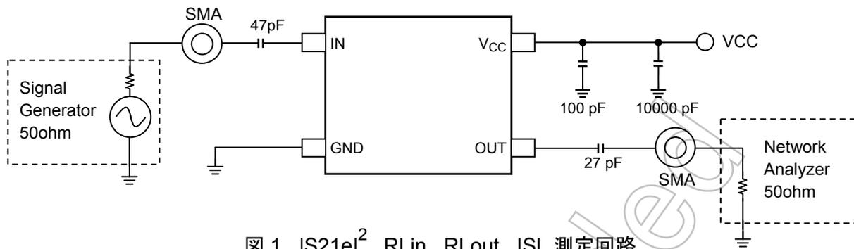
図 1 .  $|S21e|^2$  ,  $R_{Lin}$  ,  $R_{Lout}$  , ISL 測定回路
