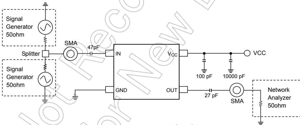
図 3 . OIP3 , IIP3 測定回路
