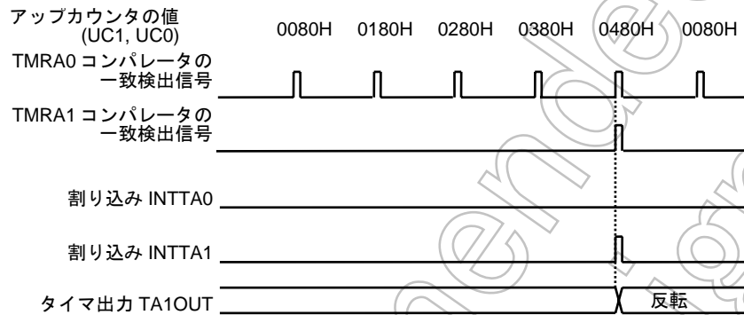
図 3.7.12 16 ビットタイマモードによるタイマ出力
