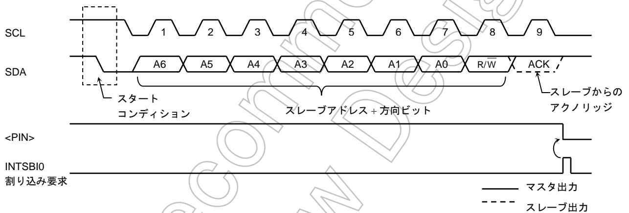
図 16-9 スタートコンディションとスレーブアドレスの発生
