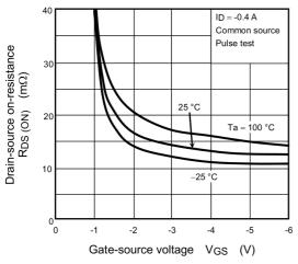
Fig. 7.3 R<sub>DS(ON)</sub> - V<sub>GS</sub>
