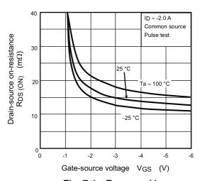
Fig. 7.4 R<sub>DS(ON)</sub> - V<sub>GS</sub>
