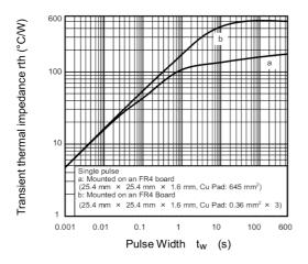
Fig. 7.13 r<sub>th</sub> - t<sub>w</sub>
