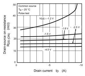
Fig. 7.5 R<sub>DS(ON)</sub> - I<sub>D</sub>
