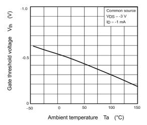
Fig. 7.7  $V_{th}$  -  $T_a$
