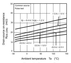
Fig. 7.6 R<sub>DS(ON)</sub> - T<sub>a</sub>
