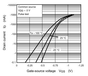
Fig. 7.2  $I_D$  -  $V_{GS}$
