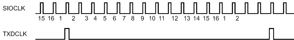
图 12-7 在 UART 模式下发送时钟的产生
