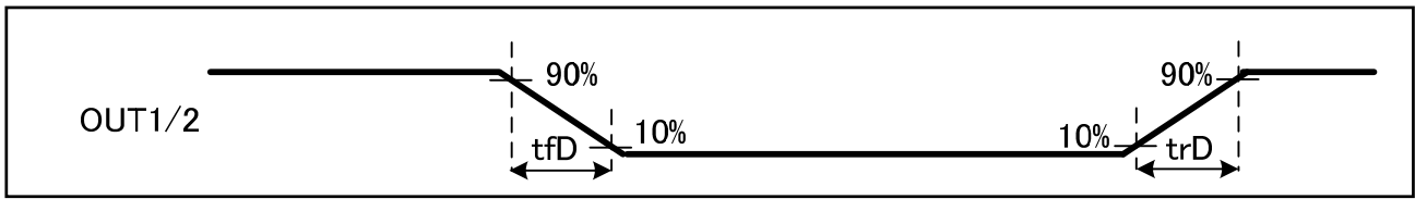
図 10.9-1 ドライバ出力スルーレート(SR)
