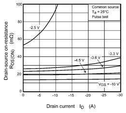
Fig. 8.5 R<sub>DS(ON)</sub> - I<sub>D</sub>
