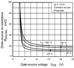
Fig. 8.3 R<sub>DS(ON)</sub> - V<sub>GS</sub>
