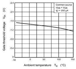
Fig. 8.7 V<sub>th</sub> - T<sub>a</sub>
