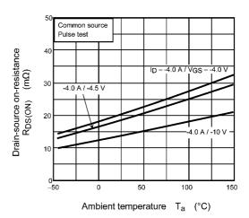
Fig. 8.6 R<sub>DS(ON)</sub> - T<sub>a</sub>
