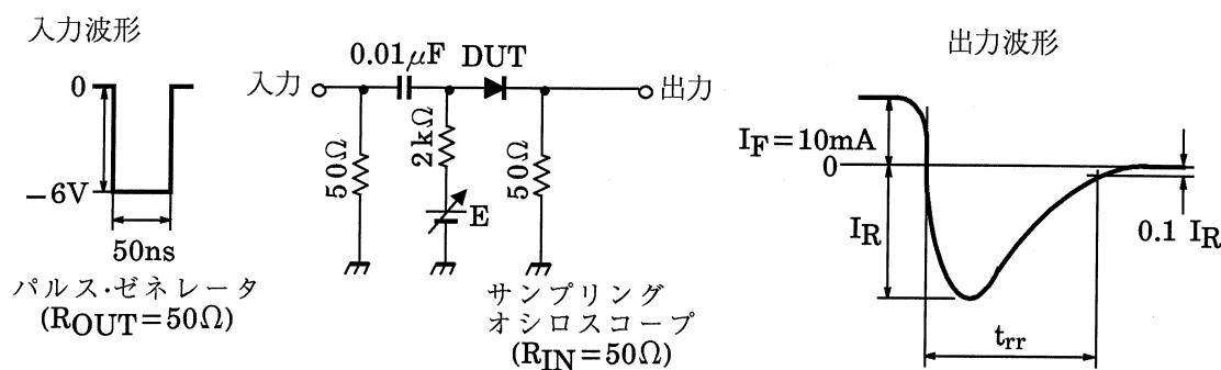
図 1. 逆回復時間 ( $t_{rr}$ ) 測定回路
