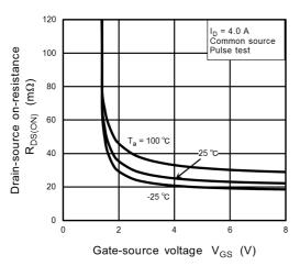
Fig. 9.1.3 R<sub>DS(ON)</sub> - V<sub>GS</sub>
