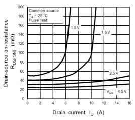
Fig. 9.1.4 R<sub>DS(ON)</sub> - I<sub>D</sub>
