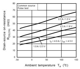
Fig. 9.1.5 R<sub>DS(ON)</sub> - T<sub>a</sub>
