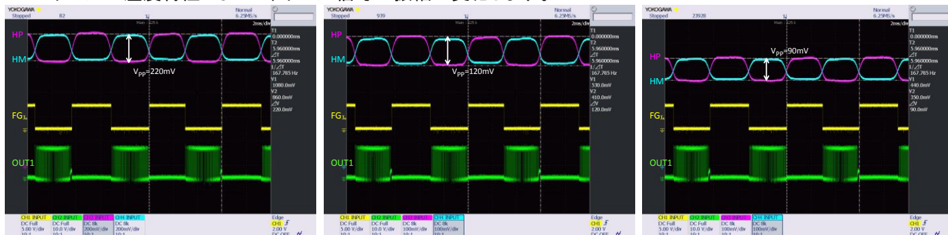
a. 低温時:ホール信号振幅 220mV
