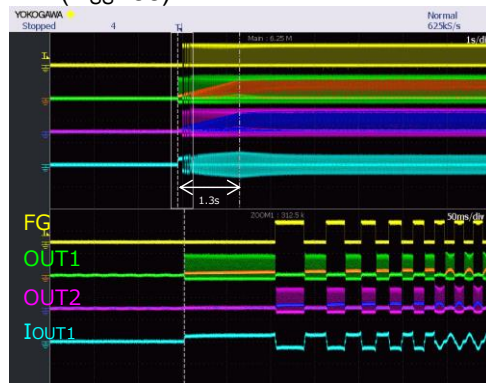
図 4.6 動作波形例 (soft start time=1.3s)
