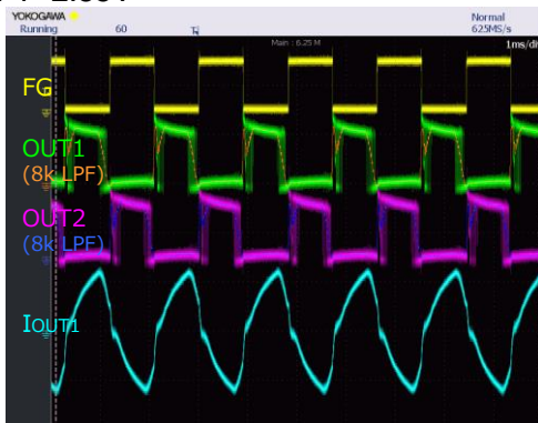
図 4.3 動作波形例 (soft switching=61°)
