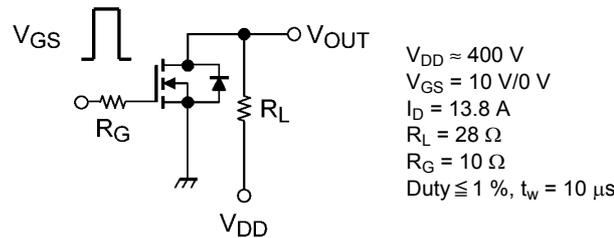
図 6.2.1 スwitchング時間の測定回路例
