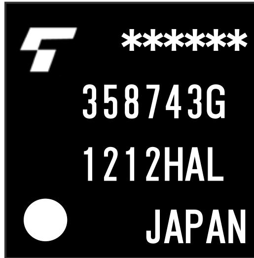
图 2.1 带HDCP密钥的封装标记，HAL添加到批次码
