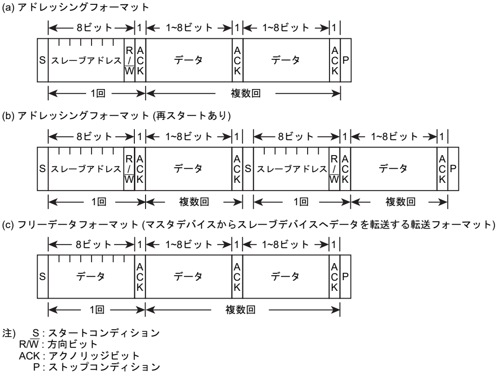
図 14-3 I2C バスモード時のデータフォーマット
