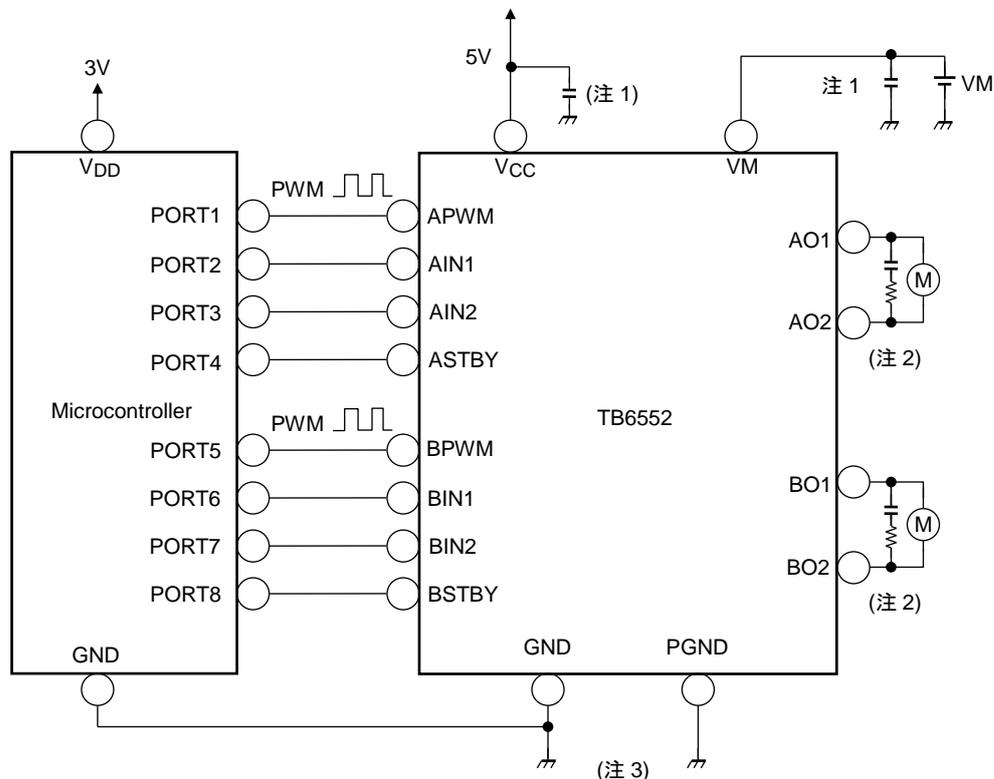
注 1: VCC(VM)と GND 間のコンデンサを IC 端子のできるだけ近くに接続してください。
