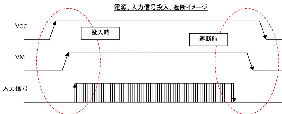
V<sub>CC</sub> 電源投入時の動作エラーを防ぐため、電源投入/遮断時は ASTBY 端子または BSTBY 端子は Low に設定してください(Standby モード)。
