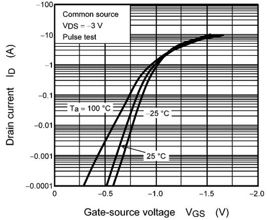
**Fig. 8.2**  $I_D - V_{GS}$
