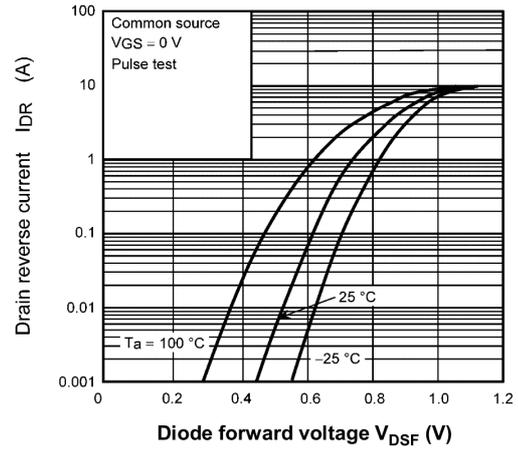
**Fig. 8.8**  $I_{DR} - V_{DSF}$
