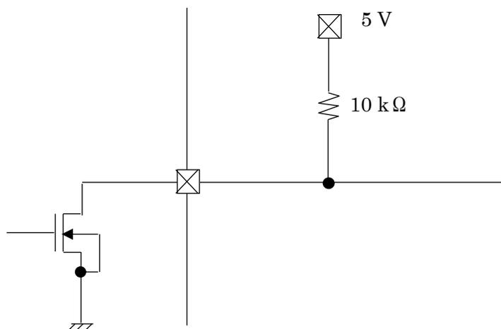
Open Drain の出力になります。出力端子を抵抗で電源に Pull Up した場合、Reset 時には Low を出力(内部 ON)、通常の動作時 (非 Reset 時)は、High(内部 Hi-Z)が出力されます。VCC 端子に Pull-Up してください。
