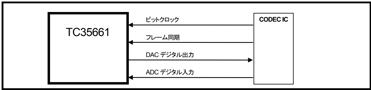
図 4-8 コーデック接続例(TC35661 がスレープモードの場合)
