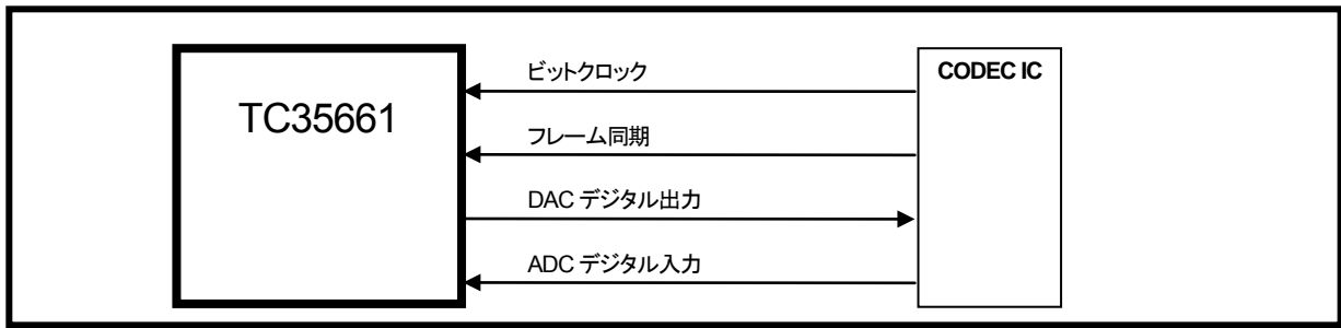
図 4-8 コーデック接続例(TC35661 がスリープモードの場合)
