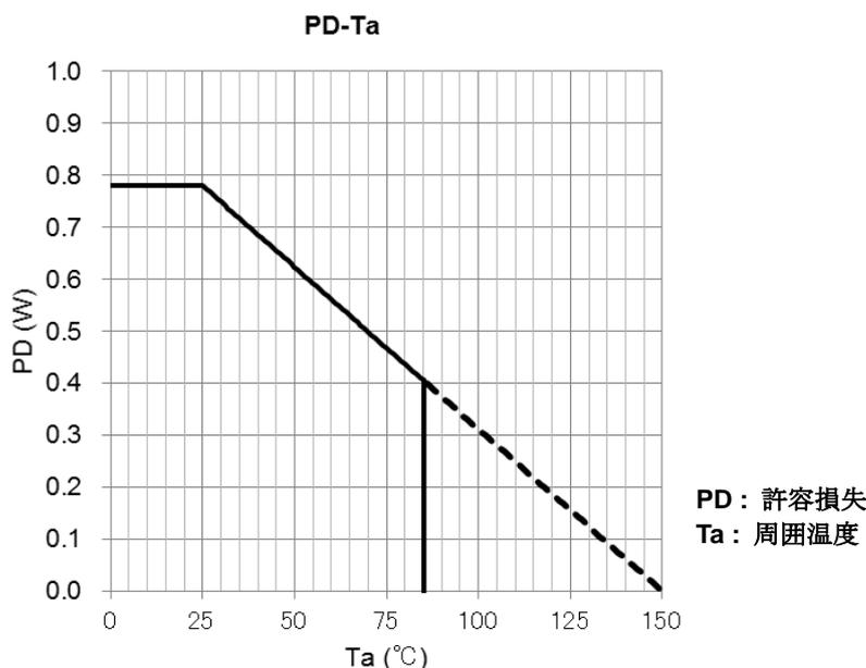
50 mm × 50 mm × 1.6 mm、Cu 40 % (Cu 厚 35 μm)、ガラスエポキシ片面基板実装時
