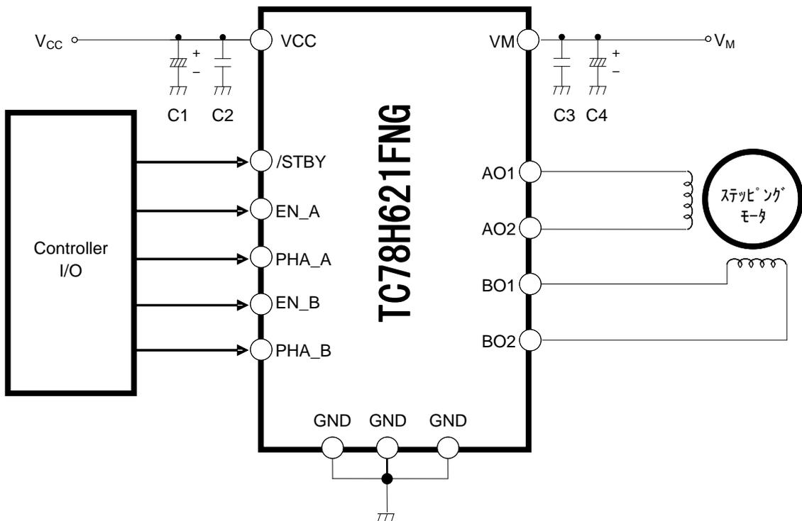
GND 配線はベタ接続とし、基板から取り出し部は1点接地とすることを推奨致します。
