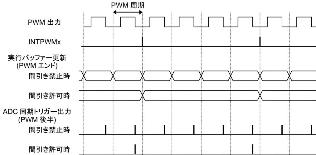
図 3.18 間引き制御タイミング例 ( $\langle INTPRD[1:0]\rangle = 11$  の場合)
