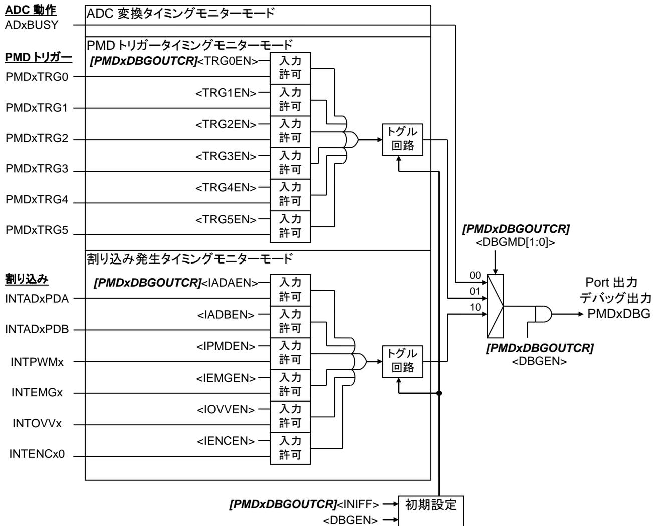
図 3.19 デバッグ出力回路構成図
