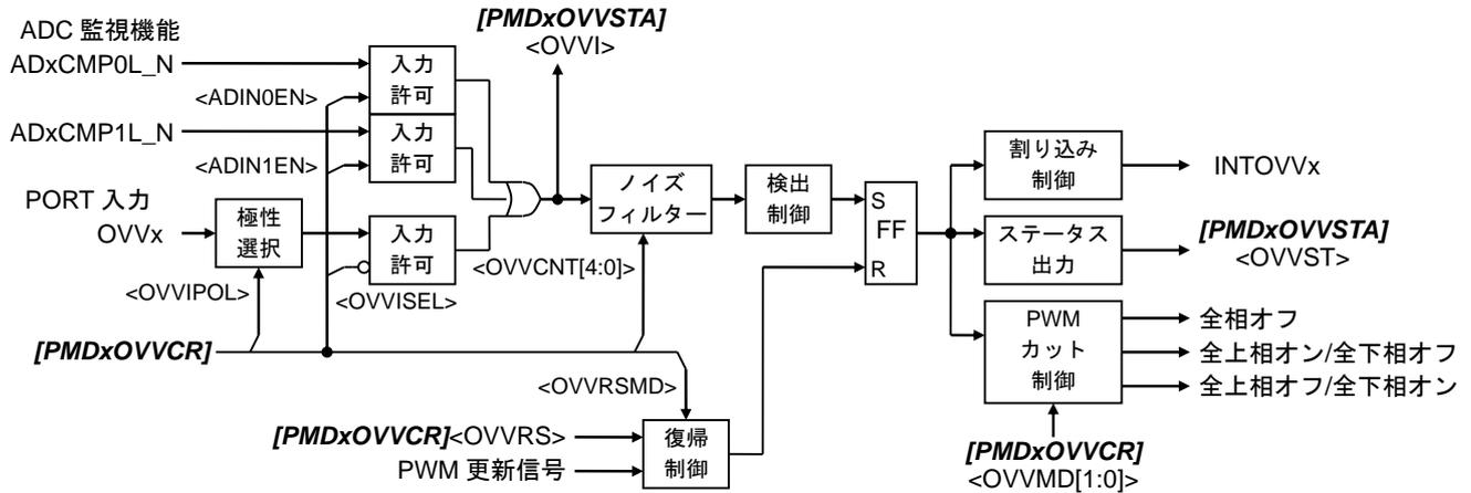
図 3.10 OVV保護制御回路
