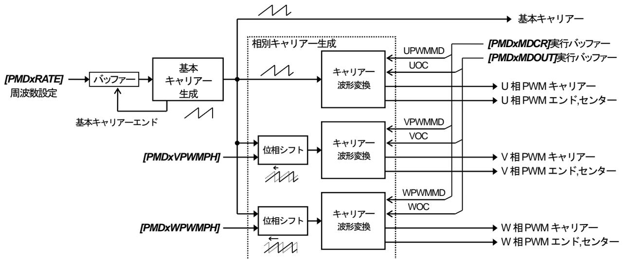
図 3.1 PWMキャリアー生成回路構成
