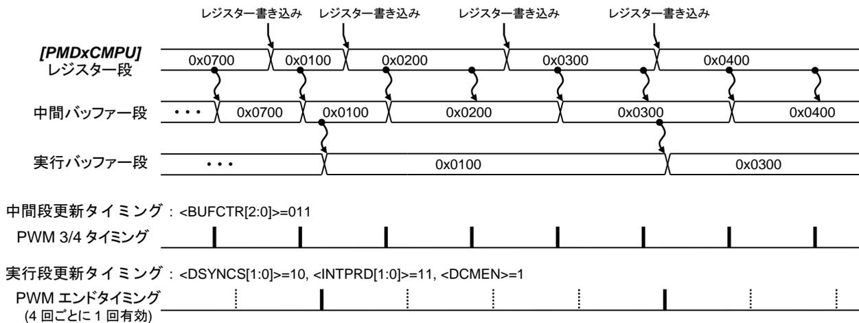
図 3.16 [PMDxCMPU]のトリプルバッファ更新タイミング例
