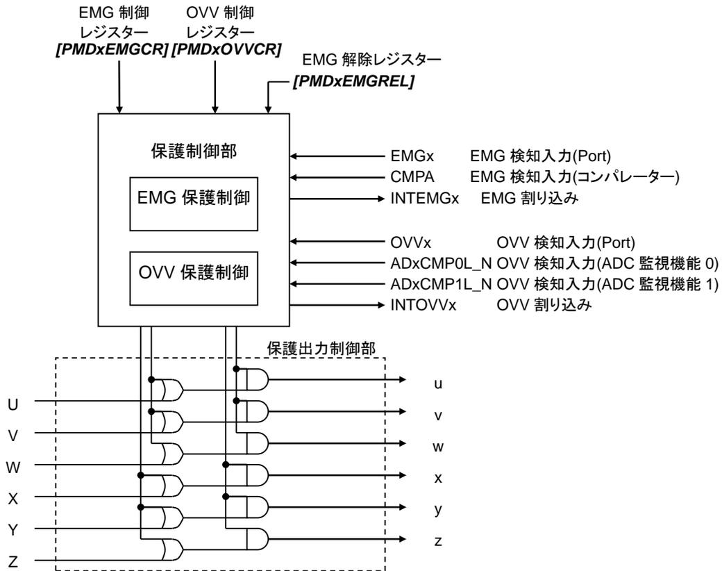
図 3.8 保護制御回路
