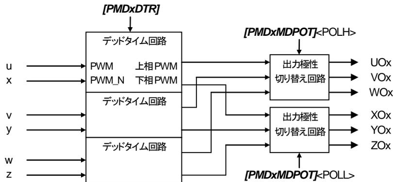
図 3.11 デッドタイム制御回路
