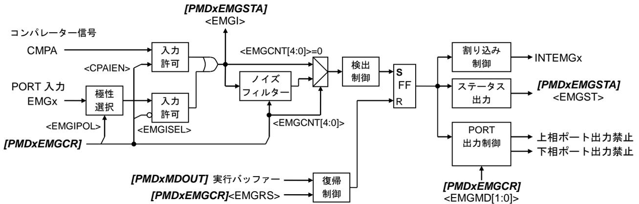
図 3.9 EMG保護制御回路
