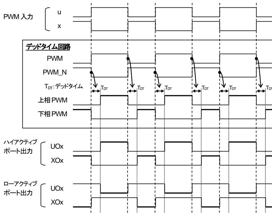
図 3.14 デッドタイム制御回路波形
