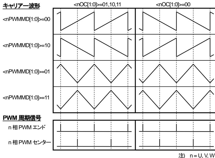
図 3.4 キャリアー波形変換出力波形
