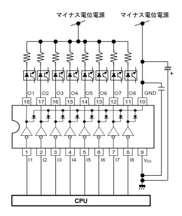
電圧安定化およびノイズリジェクトのため、 $V_{CC}$  ラインに 0.01  $\mu$ F ~ 1  $\mu$ F 程度の積層セラミックコンデンサや 10  $\mu$ F ~ 100  $\mu$ F 程度の電解コンデンサを接続してください。なお、コンデンサはできるだけ IC の近くに接続頂くことを推奨致します。
