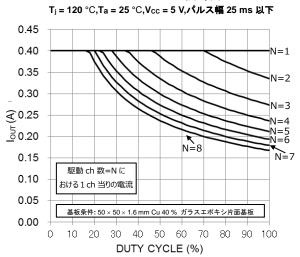
I<sub>OUT</sub> - DUTY CYCLE TBD62786AFNG 基板実装時
