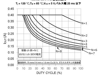
I<sub>OUT</sub> - DUTY CYCLE TBD62786APG 基板実装時
