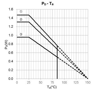
①APG タイプ単体 ②AFWG タイプ基板実装時 (75×114×1.6 mm Cu 20 % ガラスエポキシ片面基板) ③AFNG タイプ基板実装時 (50×50×1.6 mm Cu 40 % ガラスエポキシ片面基板)
