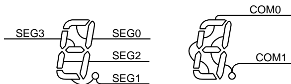
図 15-7 COM, SEG 端子接続例
