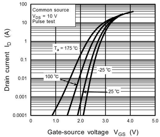
**Fig. 9.2  $I_D - V_{GS}$**
