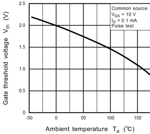
**Fig. 9.7  $V_{th} - T_a$**
