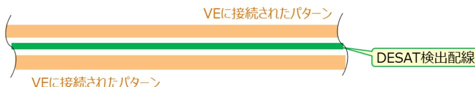
図 3.2 DESAT 回路配線パターンのシールドイメージ
