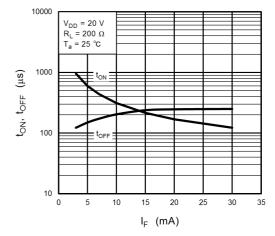
Fig. 12.1.8 t<sub>ON</sub>,t<sub>OFF</sub> - I<sub>F</sub>
