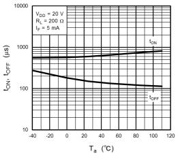
Fig. 12.1.7 t<sub>ON</sub>,t<sub>OFF</sub> - T<sub>a</sub>
