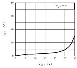
Fig. 12.1.10 I<sub>OFF</sub> - V<sub>OFF</sub>
