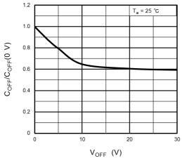
Fig. 12.1.11 C<sub>OFF</sub>/ C<sub>OFF</sub>(0 V) - V<sub>OFF</sub>
