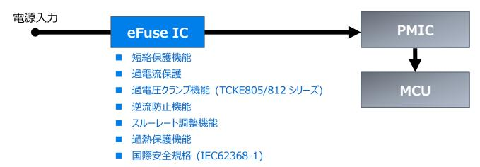
図 2.1 eFuse IC の使用例
