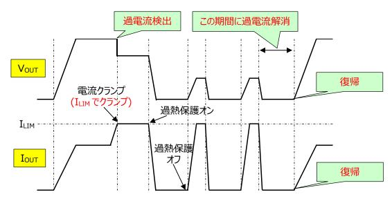
図 3.4 過電流保護動作のタイミングチャート (オートリトライタイプ)
