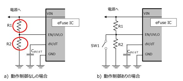
図 3.19 EN/UVLO 端子の接続例 (V<sub>IN</sub>抵抗分割)
