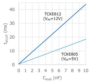
図 3.13 C<sub>dV/dT</sub>-t<sub>dV/dT</sub>特性
