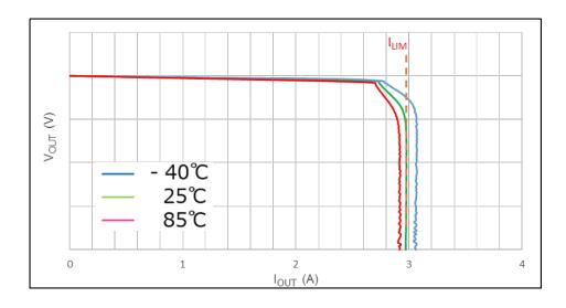
図 3.6 過電流保護クランプ動作時の出力電圧 - 電流特性
