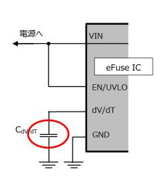
図 3.12 dV/dT 端子周辺外付け回路
