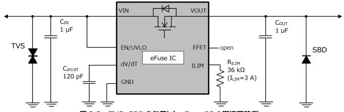
図 2.3 TVS、SBD を併用した eFuse IC の周辺回路例
