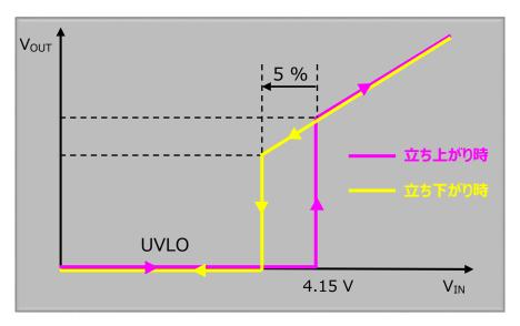
図 3.15 低電圧誤動作防止回路動作
