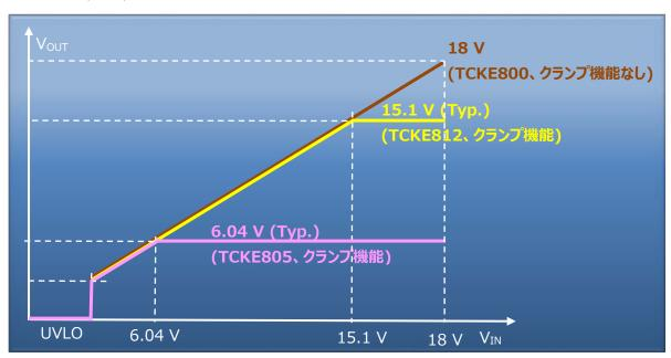
図 3.10 TCKE800/805/812 の過電圧特性(V<sub>IN</sub> vs V<sub>OUT</sub>)特性
