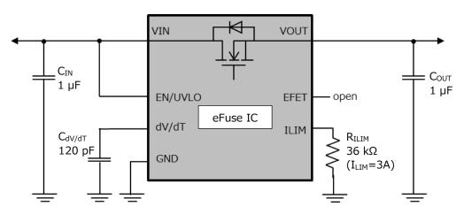
図 2.2 eFuse IC の周辺回路例
