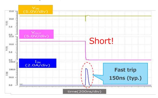
図 3.9 Fast trip 動作時の出力電圧と電流波形
