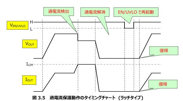
ラッチタイプの場合は過熱保護動作にラッチがかかりますので、復帰させるには EN/UVLO 端子のコントロール信号などで再
