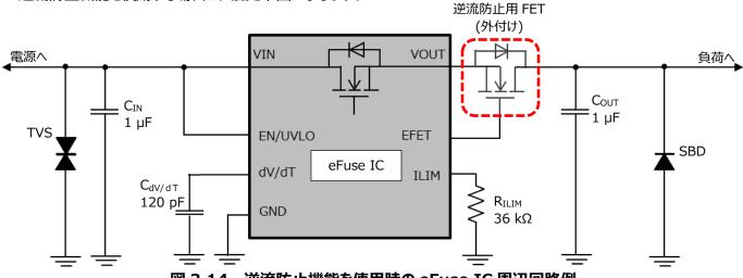
図 3.14 逆流防止機能を使用時の eFuse IC 周辺回路例
