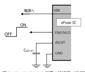
図 3.17 EN/UVLO 端子の接続例 (外部制御)
