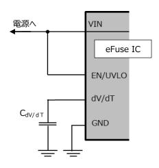
図 3.16 EN/UVLO 端子の接続例 (VIN 直結)
