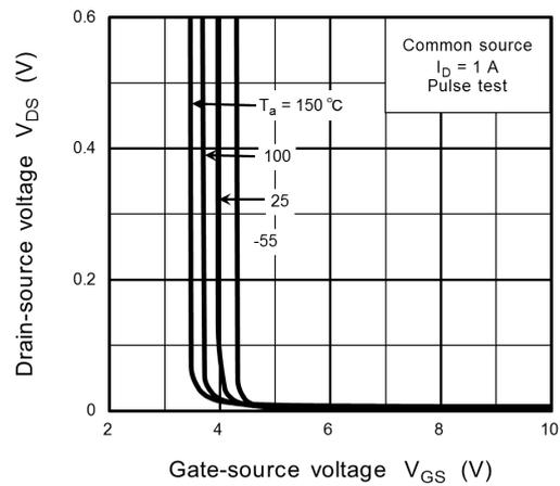
**Fig. 8.6  $V_{DS} - V_{GS}$**
