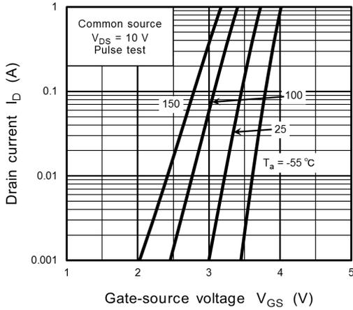
**Fig. 8.7  $I_D - V_{GS}$**
