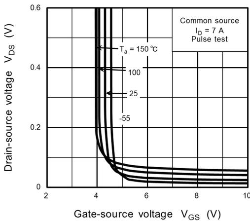
**Fig. 8.5  $V_{DS} - V_{GS}$**
