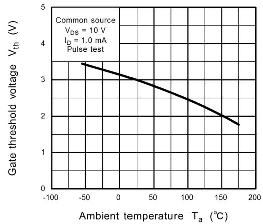
**Fig. 8.12  $V_{th} - T_a$**
