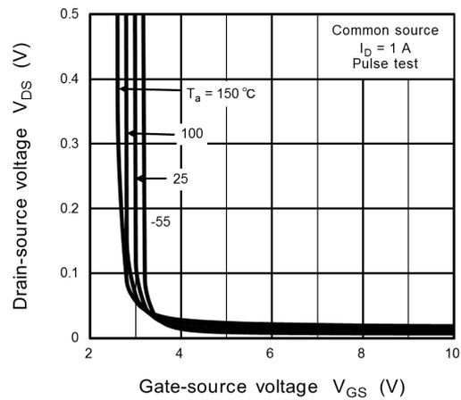
**Fig. 8.6  $V_{DS} - V_{GS}$**
