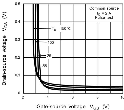
**Fig. 8.5  $V_{DS} - V_{GS}$**
