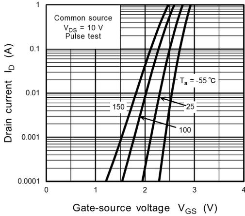
**Fig. 8.7  $I_D - V_{GS}$**
