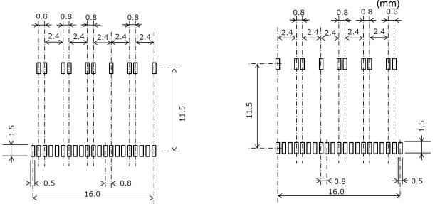
Figure 5 P-HSSOP31-0918-0.80-001 pad dimensions
