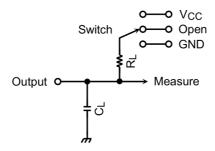
Fig. 11.8.1 AC Test Circuit
