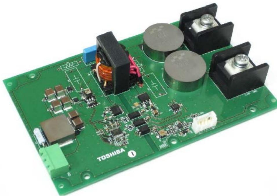
図 1.1 DC-DC コンバーター外観
