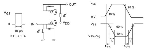
Fig. 6.3.1 Switching Time Test Circuit
