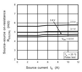
Fig. 9.2 R<sub>SS(ON)</sub> - I<sub>S</sub>
