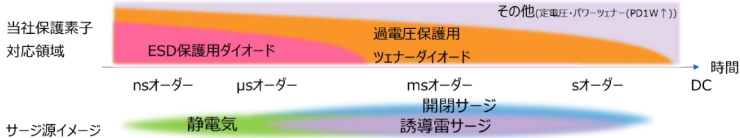
図 4.1 ESD 保護用ダイオードと過電圧保護に適したツェナーダイオードの対応領域
