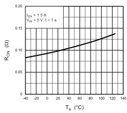
Fig. 12.4 R<sub>ON</sub> - T<sub>a</sub>
