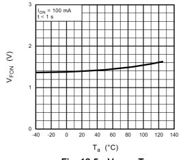
Fig. 12.5 V<sub>FON</sub> - T<sub>a</sub>
