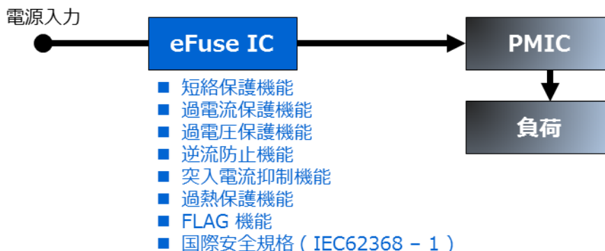
図 2.1 eFuse IC の使用例
