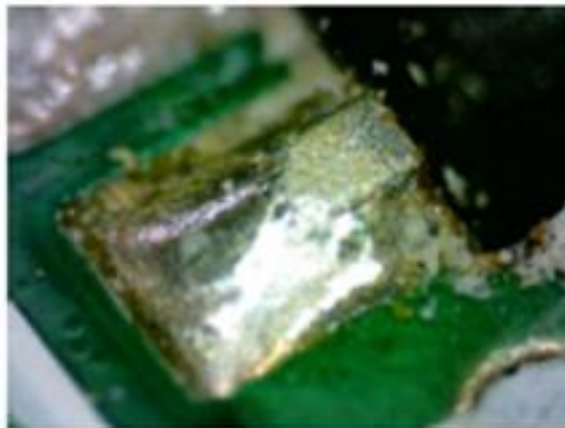
図 4.2 アルミ放熱板取り付け TCT 3000cycle 後の基板実装はんだ状態
