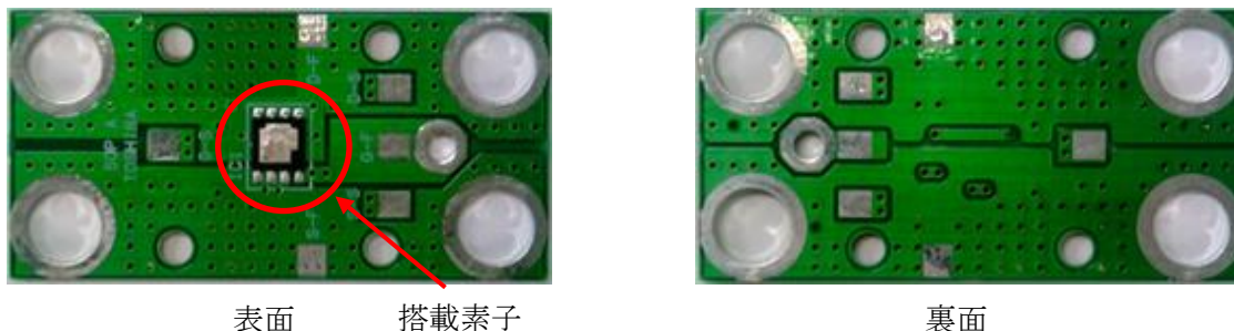
図 3.3 トッププレートの効果評価基板への素子搭載状況
