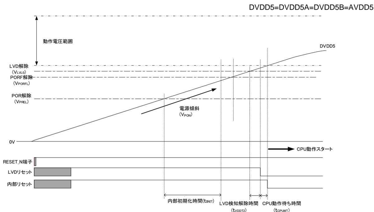
図 3.4 LVDリセットによるリセット動作
