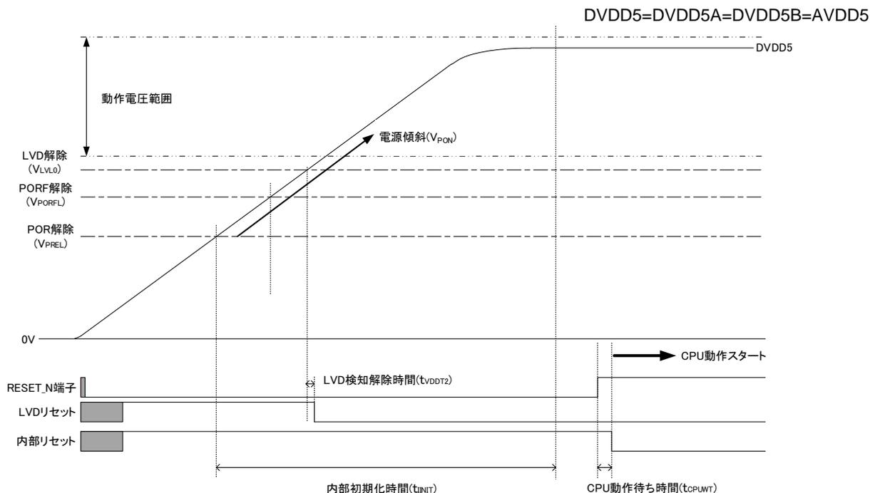
図 3.2 RESET\_N端子によるリセット動作(1)
