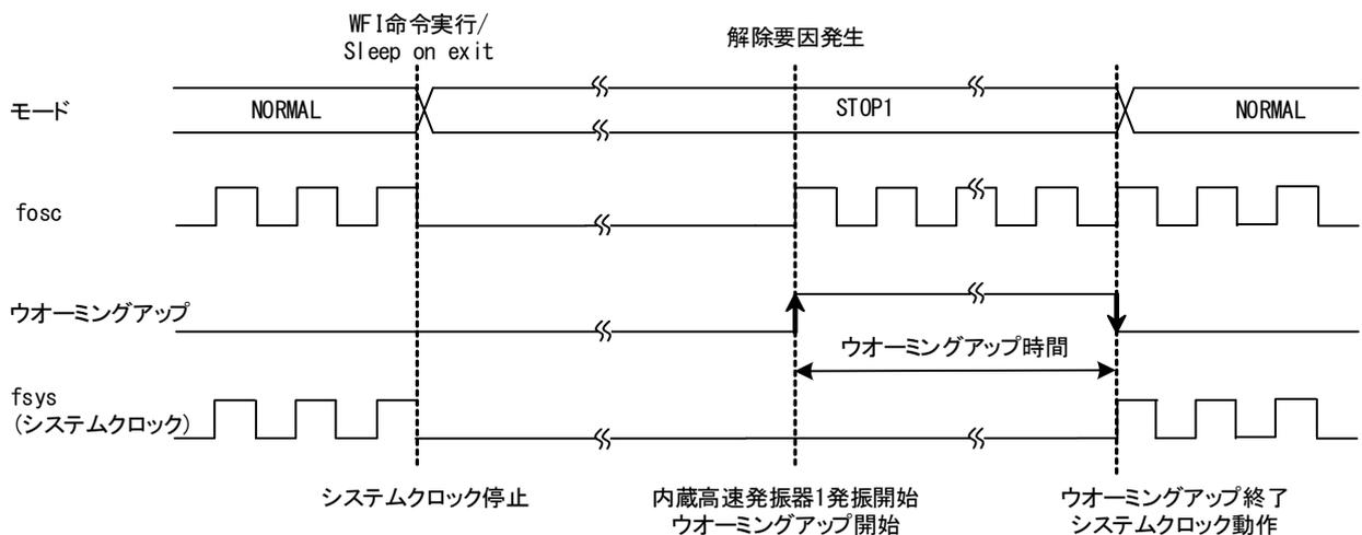
図 1.3 NORMAL→STOP1→NORMAL 動作モード遷移
