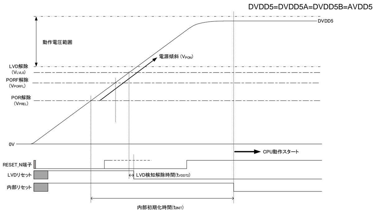
図 3.3 RESET\_N端子によるリセット動作(2)
