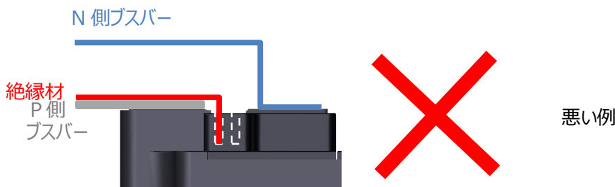
図 2.5.5 P-N 主回路配線部材の間隔をあけることにより、主回路インダクタンスが増加する例
