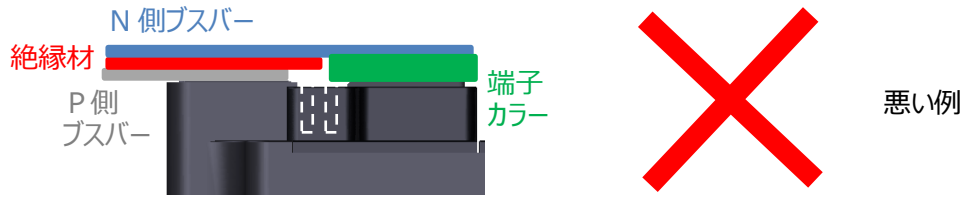
図 2.5.7 端子カラーが大きすぎることによって P-N 間絶縁距離が不足する例 (図は N 側カラーの例ですが、P 側カラーの場合も同様です)
