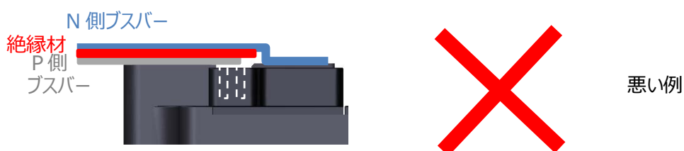
図 2.5.6 P 側ブスバーが N 側にずれることによって P-N 間絶縁距離が不足する例
